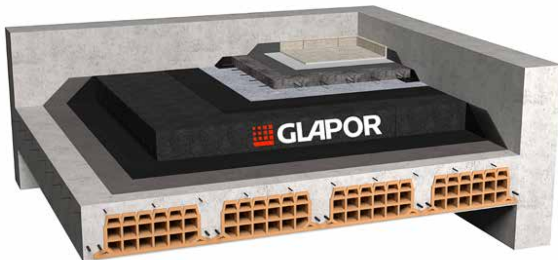
Stratigrafia isolamento tetto piano con pavimento calpestabile
